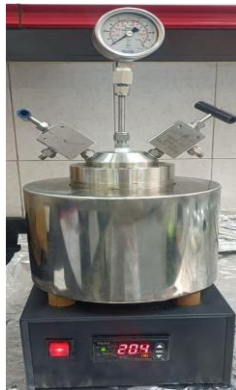
شکل ۱- راکتور کربونیزاسیون هیدروترمال مورد استفاده در این مطالعه
