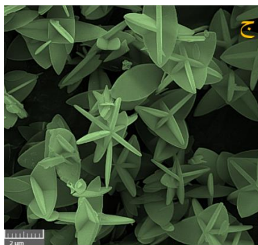
شکل ۱. تصاویر SEM جاذب‌های سنتز شده (الف: ZIF-8 Octa، ب: Cu-ZIF-8، ج: ZIF-8 Leaf)
