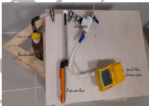
شکل ۳. سامانه اندازه‌گیری حجم بیوگاز و درصد متان تولید شده
