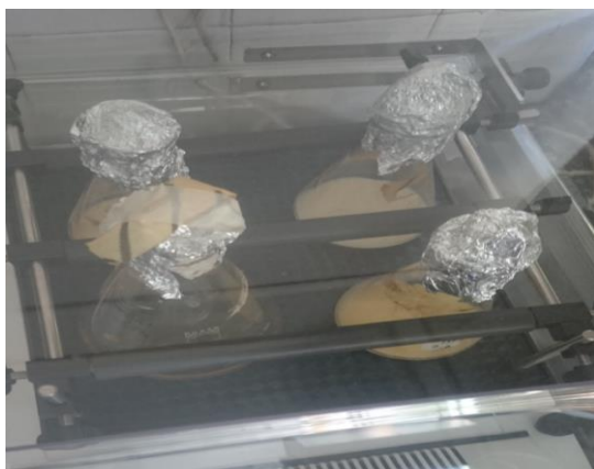
شکل ۱- نمونه‌های حاوی مخلوطی از روغن برش، نوترینت برات و لجن به منظور بررسی امکان رشد میکروارگانیسم‌ها
