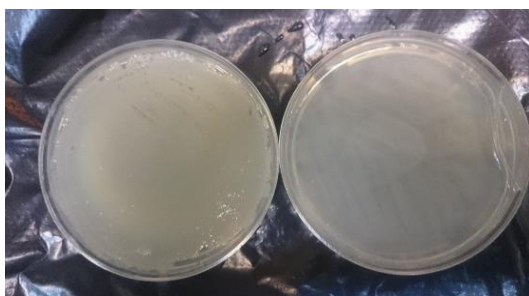
شکل ۵- بسترهای کشت داده شده از نمونه روغن برش با غلظت ۲۰ درصد ( سمت راست) و نمونه بدون حضور روغن برش (نمونه شاهد)
