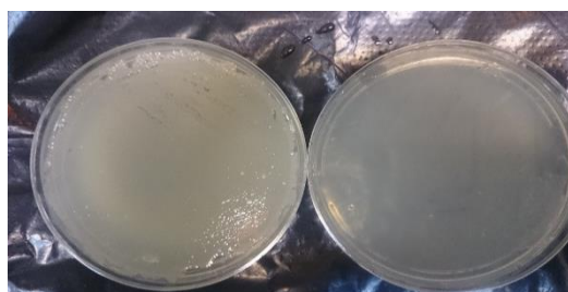
شکل ۴- بسترهای کشت داده شده از نمونه روغن برش با غلظت ۲۰ درصد ( سمت راست) و نمونه بدون حضور روغن برش (نمونه شاهد)
