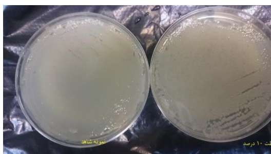
شکل ۳- سترهای کشت داده شده از نمونه روغن برش با غلظت ۱۰ درصد (سمت راست) و نمونه بدون حضور روغن برش (نمونه شاهد)
