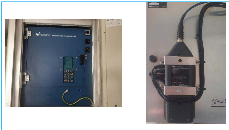
شکل ۲. تجهیزات اندازه‌گیری از صدا در ایستگاه ثابت سنجش صوت
