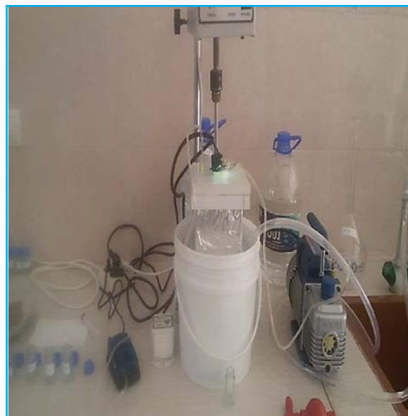
شکل ۱. راکتور فتوکاتالیستی نور پالسی با دیواره انعکاسی در حذف نیتروآنیلین
