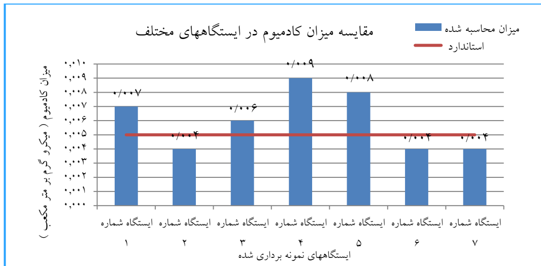
نمودار ۴. مقایسه میزان کادمیوم در ایستگاههای نمونه برداری شده
