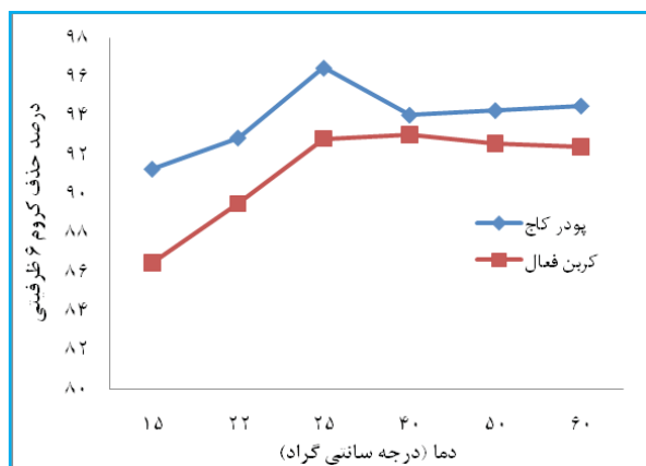
شکل ۵. اثر دما بر روی کارایی حذف (pH=۳) برای پودر و pH=۱ برای کربن فعال آن، مقدار ماده جاذب برای پودر ۳ و برای کربن ۰/۵ گرم، زمان تماس ۱۲۰ min و غلظت ۵ ppm)
