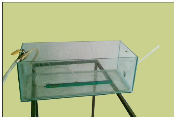
شکل ۱: پایلوت شناورسازی با هوای فشرده از جنس شیشه
